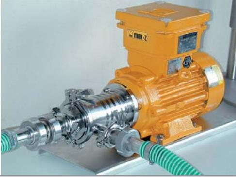
YTRON-Z mit Motor in EX-Ausführung
