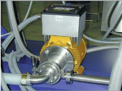
YTRON-Z mit angebautem Frequenzumformer
