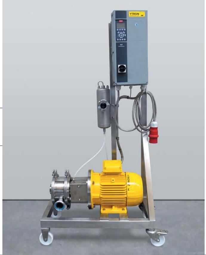
YTRON-Z mobil mit Frequenzumformer und
